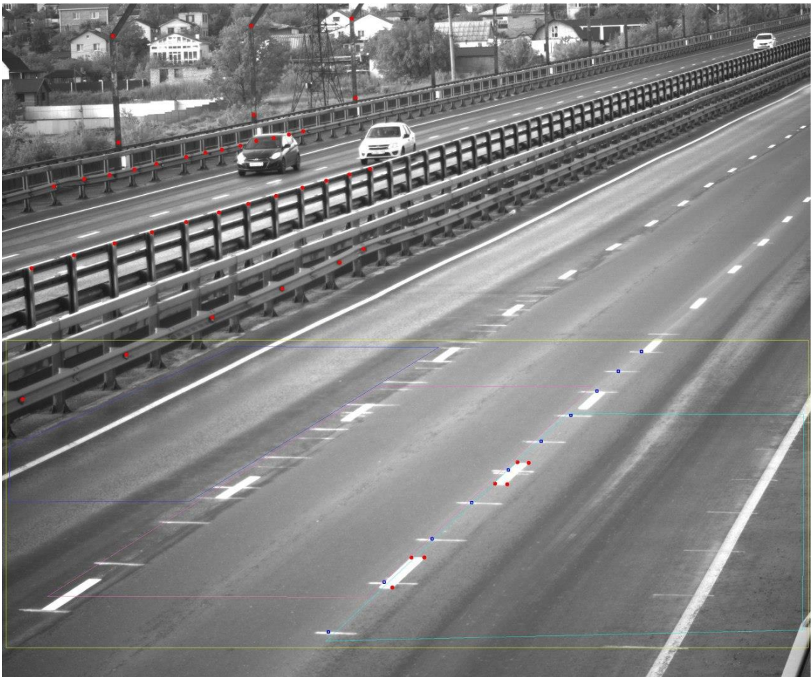
Рис. 2. Пример определения первой контрольной линии и нанесения разметки на ПЧ
